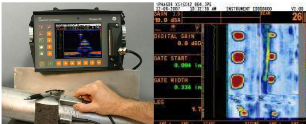
UT Phased Array en cañerías para verificación de espesor remanente (corrosión)
